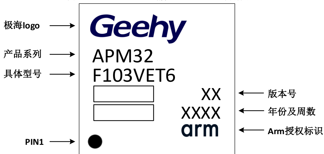
图22 LQFP100 - 100 引脚，14 x 14mm 封装标识
