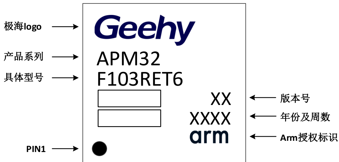
图25 LQFP64 - 64 引脚，10 x 10mm 封装标识
