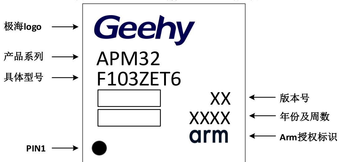
图19 LQFP144 -144 引脚, 20 x20 mm 标识图
